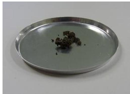
Volumen aufgrund der Trocknung reduziert
