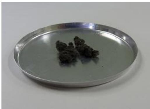
Zerbröckelte Probe auf der Schale verteilt
