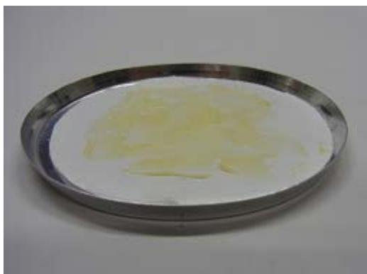
Probe mit einem Spachtel gleichmäßig auf einem Glasfaserfilter verteilt
