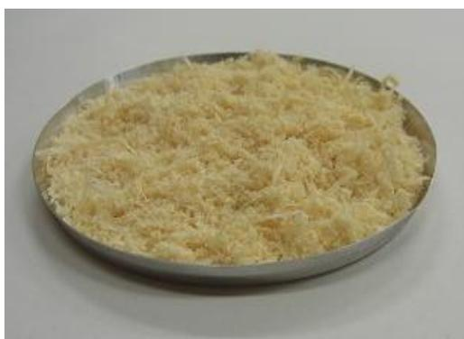
Gleichmäßig auf einer Schale mit einer Schicht von ca. 4mm verteilt
