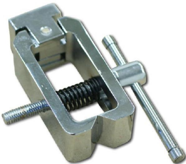
Spitzklammer-Aufsatz für Zug- und Reißtests bis 500 N (z. B.
